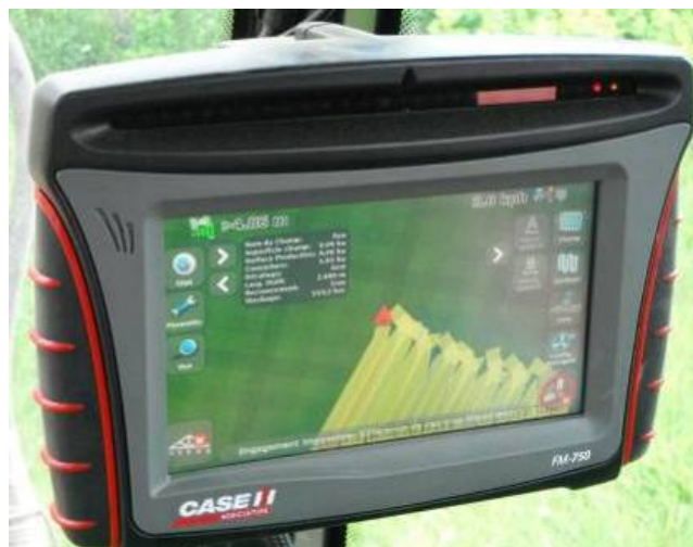
Figure 1. Base de positionnement RTK (gauche) et console GPS Trimble FM 750 (centre).
